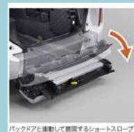
バックドアと連動して展開するショートスロープ
