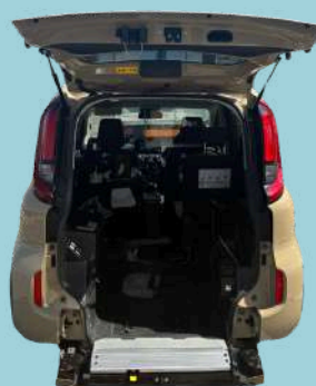
バックドアと連動して展開するショートスロープ
